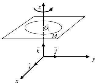
тельно центра ее вращения, обозначим через  $\vec{\rho}$ . Вектор  $\vec{v}(M) = [\vec{\omega} \times \vec{\rho}]$  является вектором линейной скорости вращающейся частицы жидкости.
