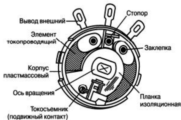
Рис. 5.2. Устройство переменного резистора со стороны резистивного слоя (защитная крышка снята)
