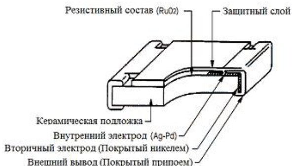
Рис. 4.2. Схема устройства резистора для поверхностного монтажа
