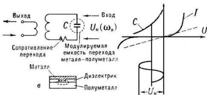
Рис. 6.9. Низкотемпературный параметрический усилитель: а - эквивалентная схема; б - вольтамперная характеристика перехода металл-полуметалл ( U - напряжение, I - ток) и зависимость его ёмкости C от напряжения при T < 80 К; пунктиром показана эта же характеристика при комнатной температуре (300 К); U_n и \omega_n - напряжение и частота накачки; в - переход металл-полуметалл - активный элемент усилителя
