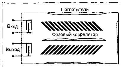
Рис. 2.24. Конструкция дисперсионного фильтра на отражательных решетках
