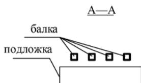
Структура гребенчатого электростатического актюатора
