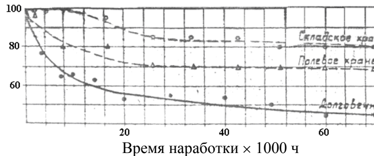
Рис. П.4.11. Кривые стабильности для 20 %-ного значения параметра U_{0L} ИС типа 106ЛБ2 при различных видах испытаний
