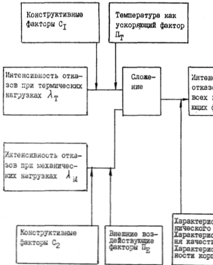
Рис. П.5.1. Структурная схема для оценки интенсивности отказов
