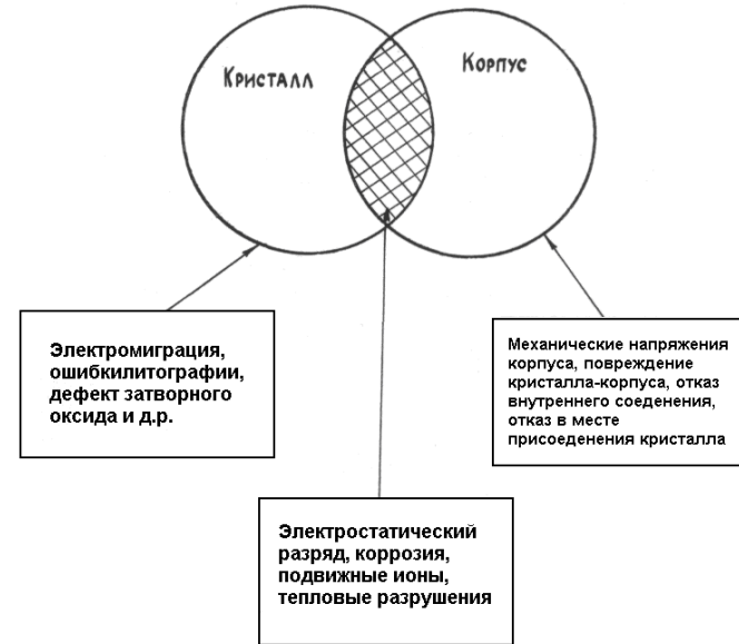
Рис. 4.1. Виды отказов ИС в корпусах
