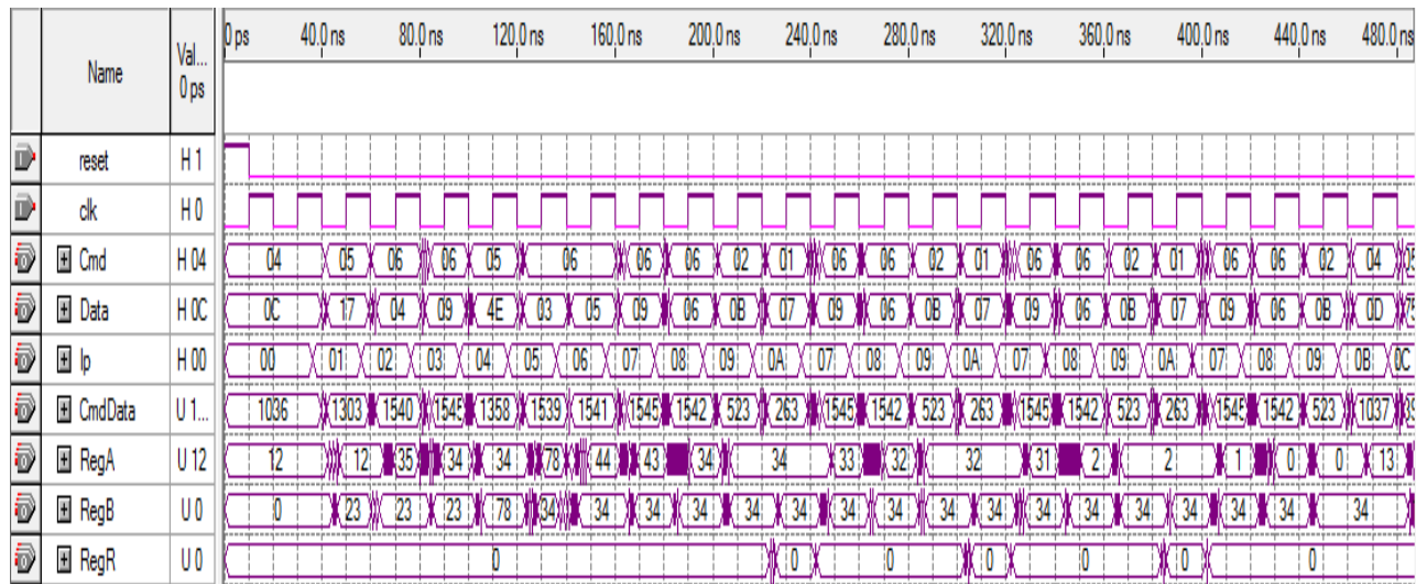
Рис.4.26. Временная диаграмма работы микропроцессорного ядра с синхронным ПЗУ на языке VHDL (код языка VHDL функциональных блоков сгенерирован с помощью приложения Simulink HDL Coder системы Matlab/Simulink)
