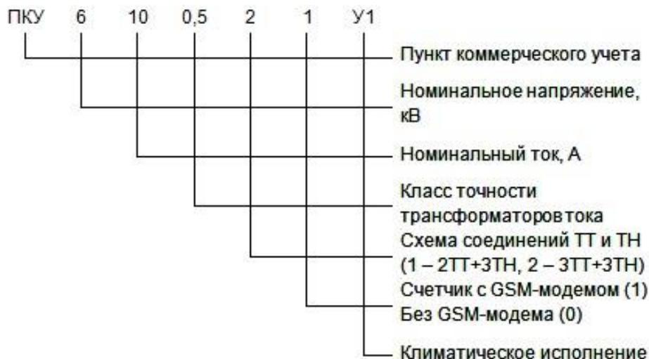
Рис. 3. Схема обозначение ПКУ
