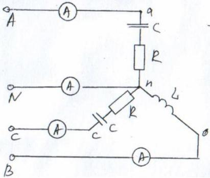
7. Несимметрична трехфазная нагрузка, соединенная «звездой», включена на симметричное линейное напряжение  $U_L=380$  В. Определить показания амперметра в фазе А.
