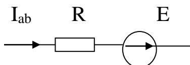
a)  $U_{ab} = -IR - E$ ; б)  $U_{ab} = -IR + E$ ; в)  $U_{ab} = IR - E$ ; г)  $U_{ab} = IR + E$ .
