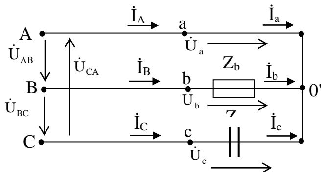
5. Определить напряжение на зажимах цепи.
