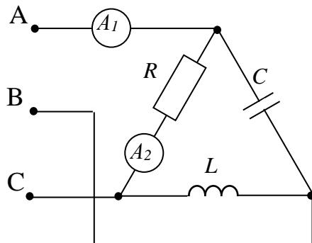
3. Определить показания вольтметров, если  $U_n = 380$  В,  $R = \omega L = 1 / \omega C = 76$  Ом.
