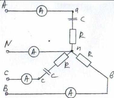
8. Несимметрична трехфазная нагрузка, соединенная «звездой», включена на симметричное линейное напряжение  $U_L=380$  В. Определить комплексное значение тока в фазе В.
