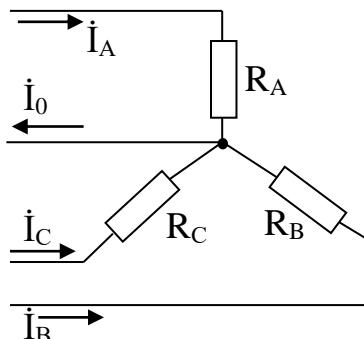
6. Несимметрична трехфазная нагрузка, соединенная «звездой», включена на симметричное линейное напряжение  $U_L=380$  В. Определить показания амперметра в фазе В при  $X_L=220$  Ом.
