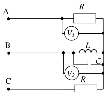
4. Трехфазный генератор работает на симметричную нагрузку, соединенную звездой. Полное сопротивление фазы  $Z = 100$  Ом при индуктивном  $\cos\varphi = 0,8$ ,  $U_n = 380$  В. Определить мощность цепи.
