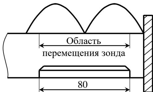
Рис. 1.7. Распределение поля вдоль волновода в области перемещения зонда
