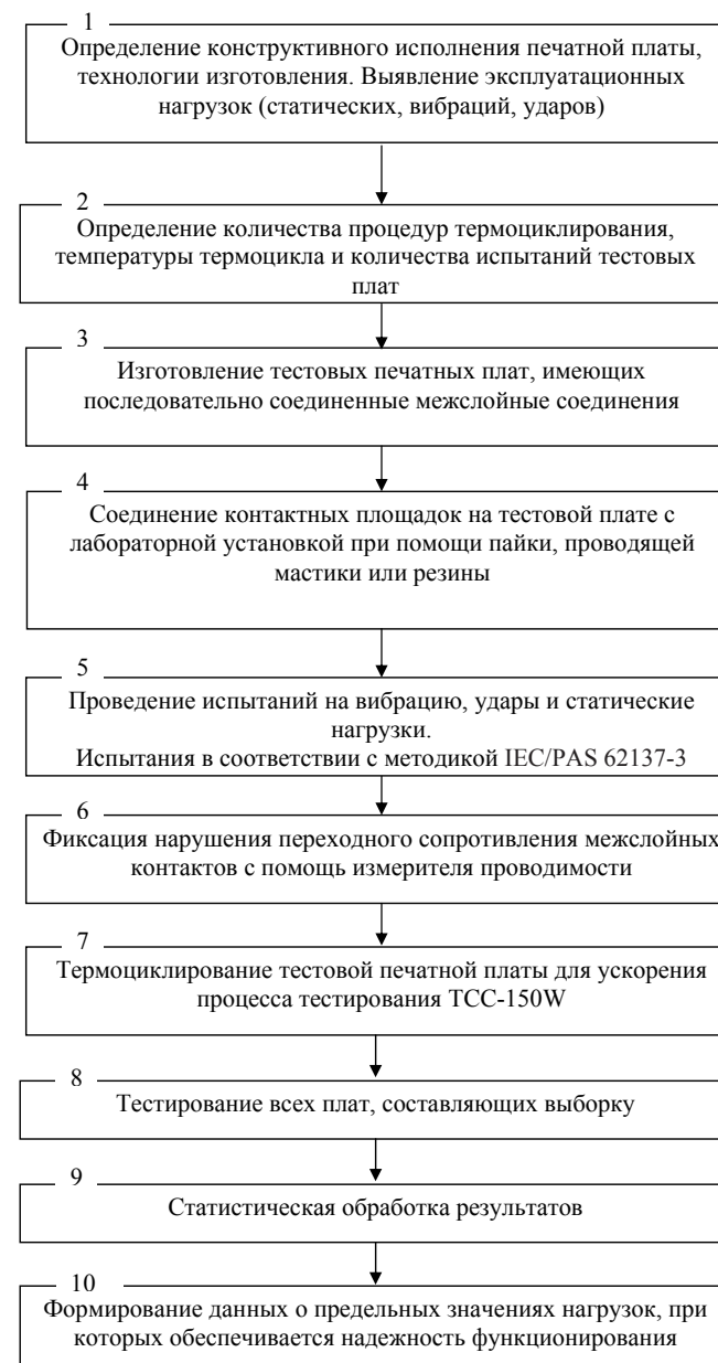
Рис 3.18. Этапы методики тестирования многослойных печатных плат на механические воздействия
