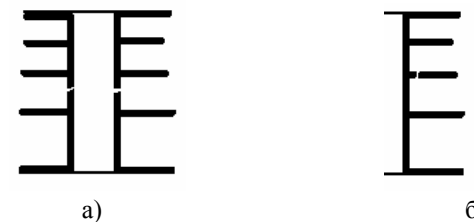
Рис. 3.17. Излом медной фольги переходных отверстий: а) излом медной металлизации вблизи центра печатной платы б) разрушением границы между медной фольгой и гальванической медью
