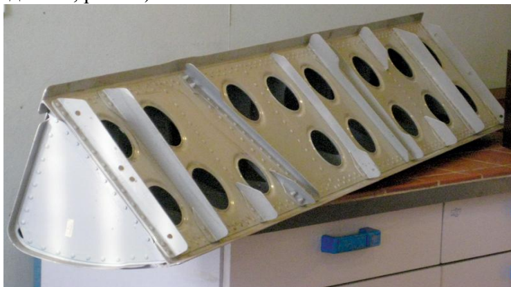
Рис.29. Носовая часть крыла самолета Ан-124 с обшивками из АЛОРа Д16/41
