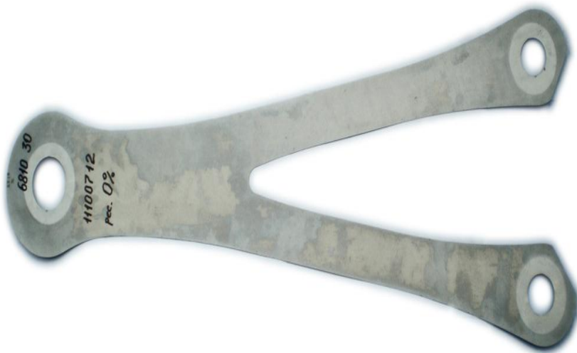
Рис.46. Пластина торсиона вертолета, изготовленная из холоднокатаной ленты стали ВНС9-Ш
