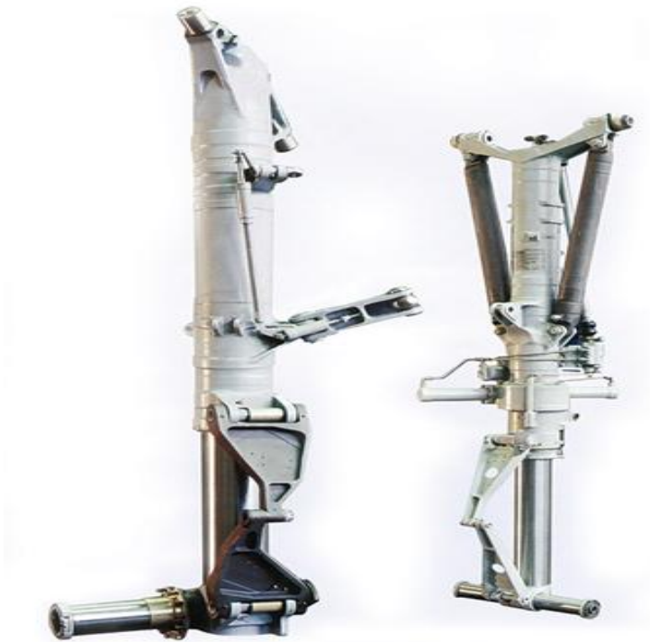
Рис.43. Стойки шасси самолета из стали ВКС-9
