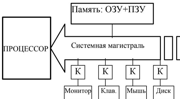
Рис. 5.3. Структурная схема ЭВМ
