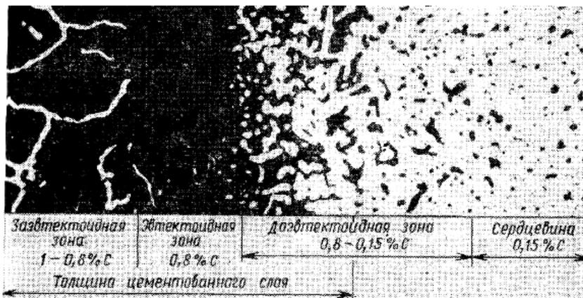
Рис. 1. Микроструктура низкоуглеродистой стали после цементации (схема).
