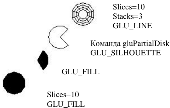
Рис. 1 Различные варианты использования команд gluDisk и gluPartialDisk .
