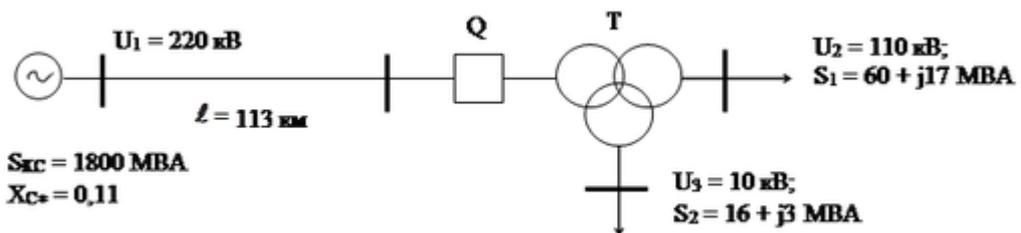
9 Выбрать мощность и тип силового трансформатора Т, а также выключатель Q для электрической схемы представленной на рисунке.
