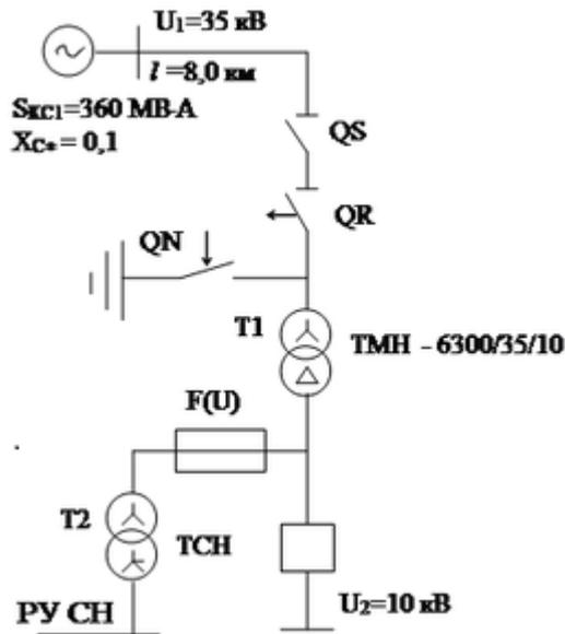
8 Для схемы, приведённой на рисунке, выбрать силовой трансформатор Т и выключатель Q. Необходимые параметры для решения задачи представлены на рисунке.
