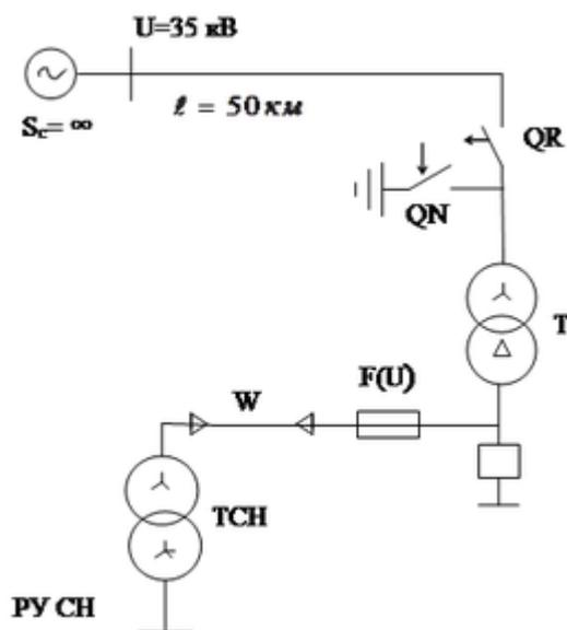
2 Для тупиковой трансформаторной подстанции изображенной на рисунке выбрать короткозамыкатель QN в РУ 35 кВ.
