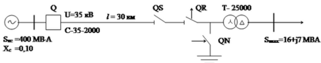
3 Для тупиковой трансформаторной подстанции изображенной на рисунке в цепи трансформатора T2 выбрать отделитель QR.
