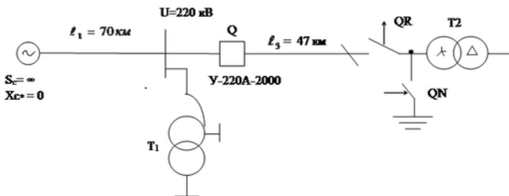
4 В электрической схеме, приведённой на рисунке, выбрать: силовые трансформаторы T1 и T2; токопроводы в РУ 10 кВ проверив их на динамическую стойкость.
