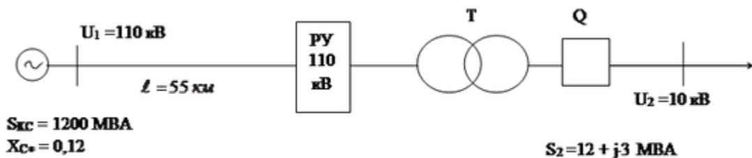
10 Определить длительность аварийной и систематической перегрузки для трансформатора с системой охлаждения Д. До момента перегрузки Т работал со следующими степенями нагрузки:  $K_3=0,4 - 2$  ч;  $K_3=0,7 - 4$  ч;  $K_3=0,5 - 2$  ч;  $K_{пер}=1,45$ ;  $токp.c.p. = 30^\circ C$ .
