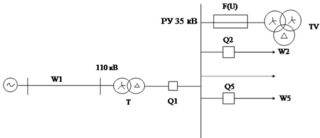
7 Выбрать тип и мощность трансформатора СН. Предохранитель F(U) в цепи ТСН. Известно: расчетная мощность СН -48 кВА; параметры системы, воздушной линии и силового трансформатора Т1 указаны на рисунке.
