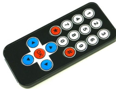
Рис. 5 Инфракрасный пульт управления
