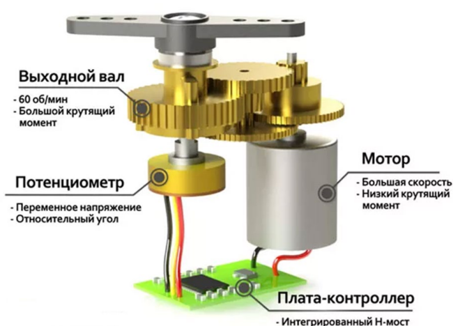
Рис. 1 Устройство сервопривода (Arduino)
