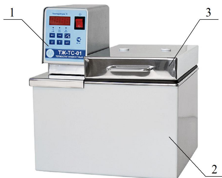
Рис. 4.1. Общий вид термостата ТЖ-ТС-01: 1 – блок терморегулирования; 2 – ванна; 3 – крышка ванны
