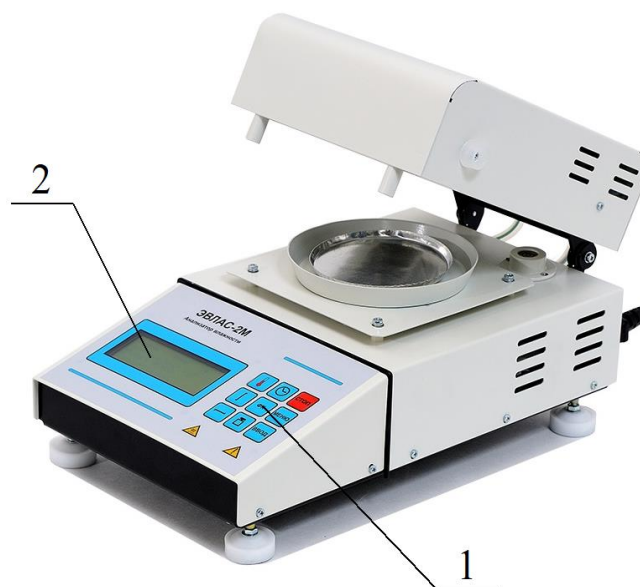
Рис. 2.1. Общий вид влагомера «ЭВЛАС-2М»: 1 – алфавитно-цифровой индикатор; 2 – клавиатура
