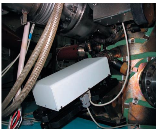
Рис. 3.24 Анализирующий блок эллипсометра, смонтированный на высоковакуумной установке эпитаксии фоточувствительных слоев кадмий-ртуть-теллур
