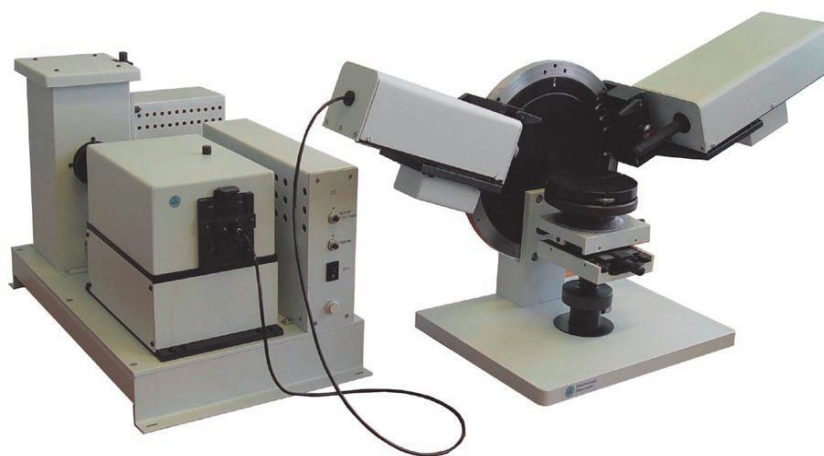
Рис.3.23 Внешний вид спектрального эллипсометра: он состоит из блока осветителя и измерительного блока, соединенных оптоволоконном.
