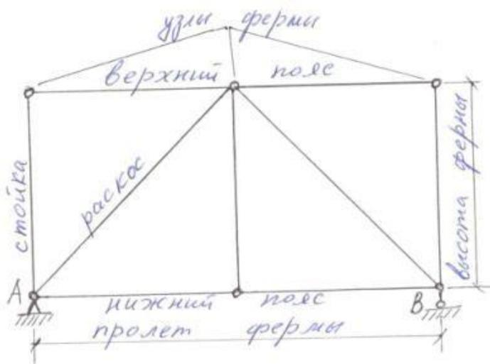
Стержни плоской фермы, расположенные по верхнему контуру, образуют верхний пояс, а расположенные по нижнему контуру – нижний пояс фермы. Вертикальные стержни называют стойками, а наклонные – раскосами.
