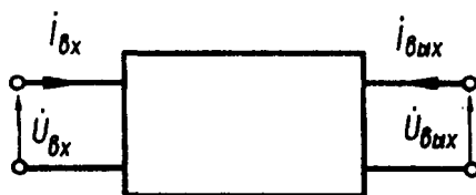
Рис. 3.4. Представление транзистора в виде линейного четырехполюсника
