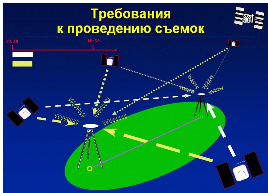
Рис. 10. Минимальные требования для проведения статических ГНСС измерений
