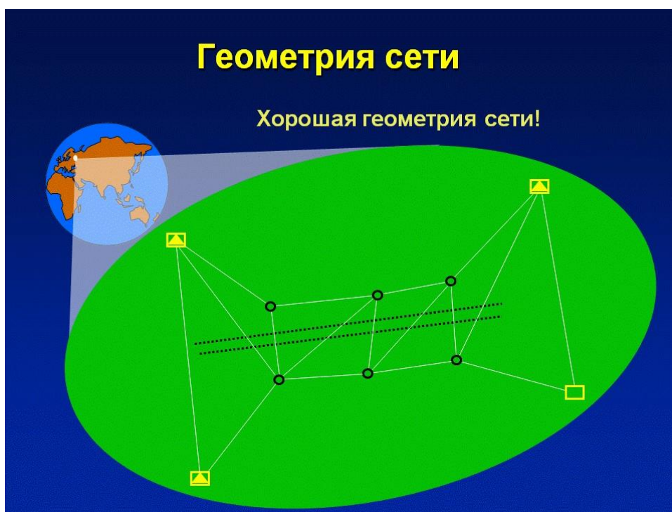
Рис. 2. Пример съемочной сети с «хорошей» геометрией
