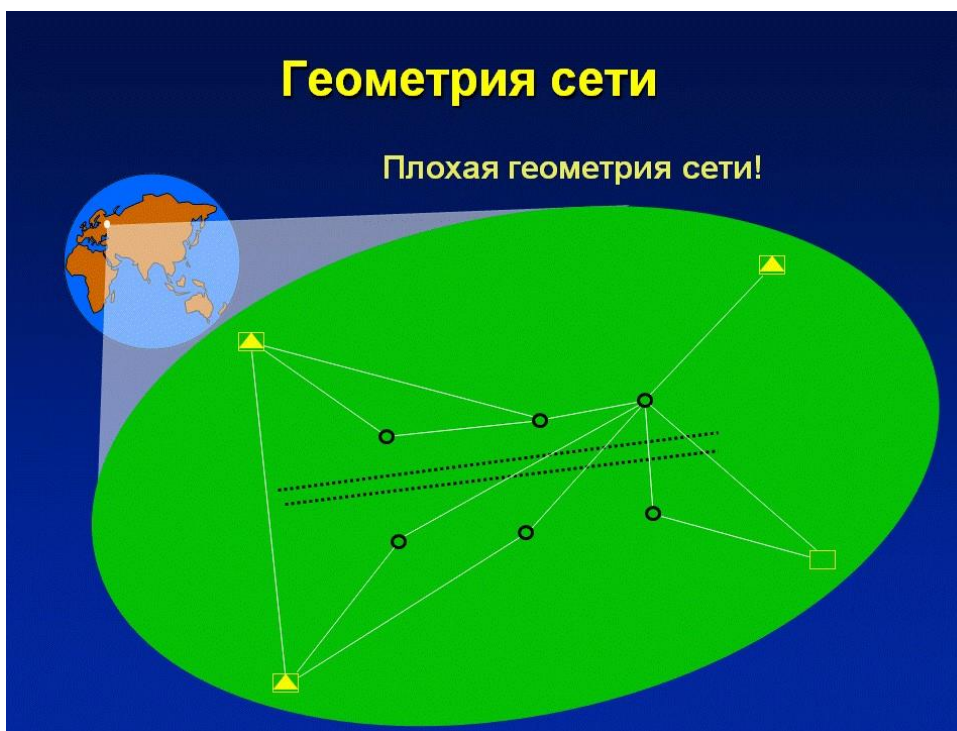
Рис. 3. Пример съемочной сети с «плохой» геометрией
