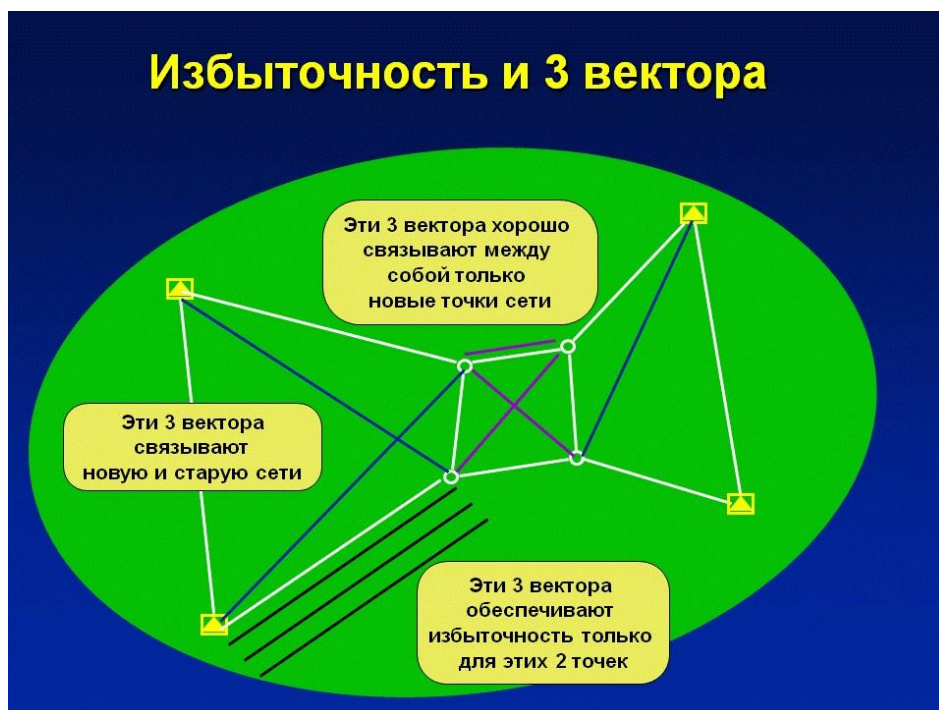
Рис. 6. Пример сети с тремя избыточными векторами разного типа
