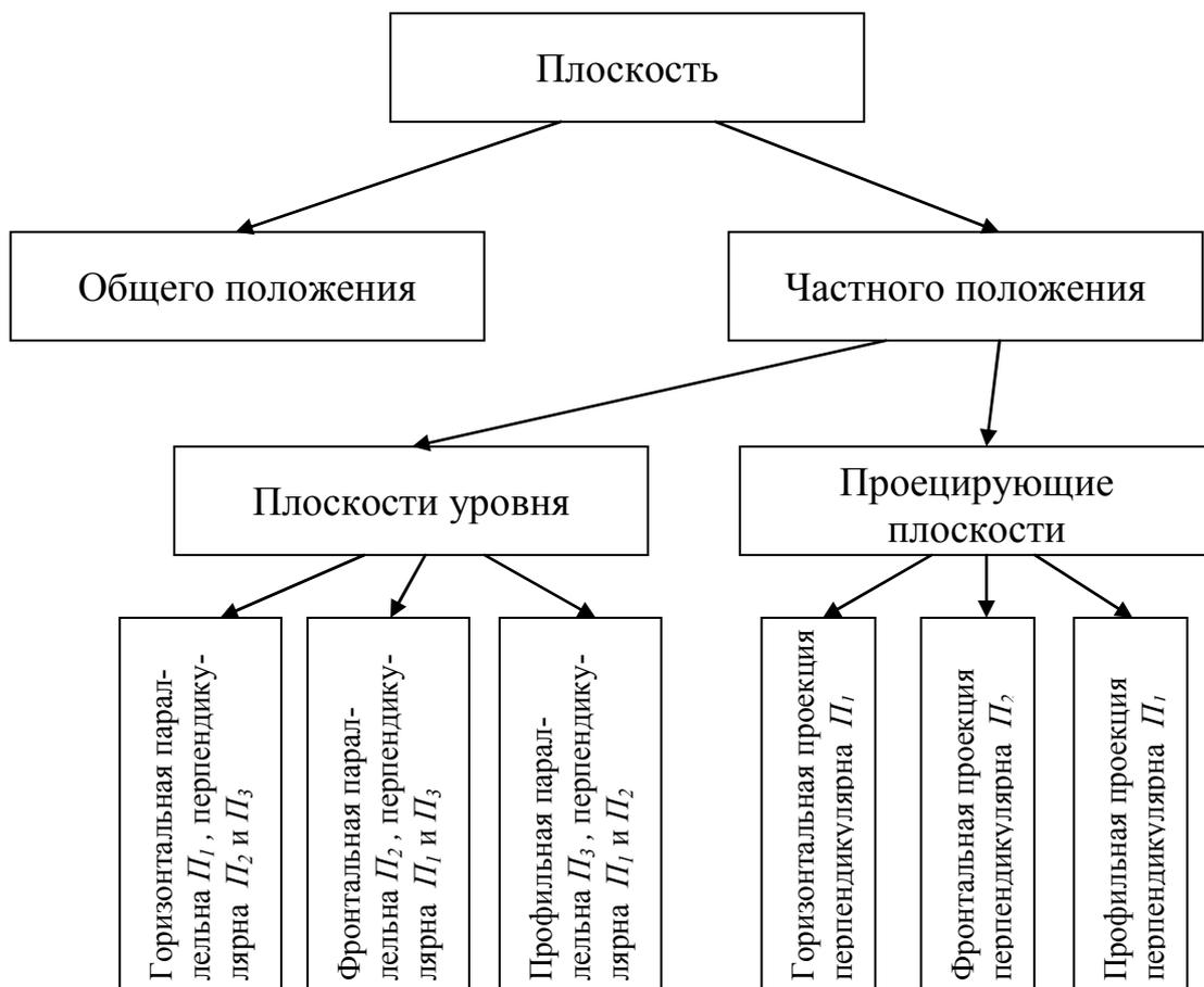
*Различные положения плоскости относительно плоскостей проекций*
