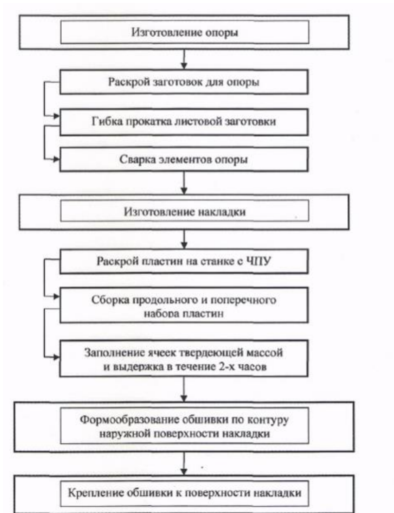
Рис. 22. Схема технологического процесса изготовления универсального пуансона
