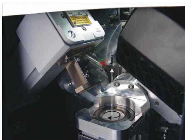
Рис. 2.7. Схема оси вращения образца, перпендикулярной его поверхности
