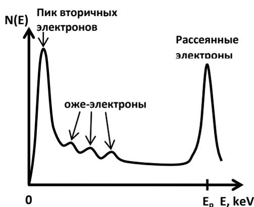
Рис. 5.5. Типичный спектр вторичных, рассеянных и оже-электронов
