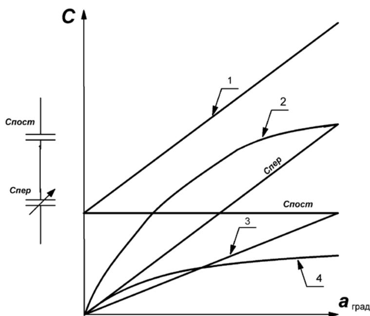
Общая емкость цепи  $C_{\text{пер}} + C_{\text{пост}}$  будет изменяться при изменении угла поворота  $\alpha$  конденсатора  $C_{\text{пер}}$  согласно графика
