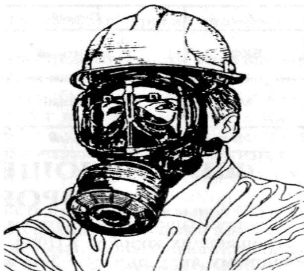
Рис. 16. Промышленный противогаз малого габарита ПФМ-1
