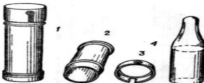
Рис. 53. Индивидуальный химический измеритель дозы ДП-70МП:
