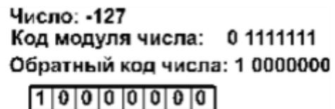
Дополнительный код положительного числа равен прямому коду этого числа. Дополнительный код отрицательного числа  $m$  равен  $2^k - |m|$ , где  $k$  - количество разрядов в ячейке. Также дополнительный код отрицательного числа образуется путём прибавления 1 к обратному коду.
