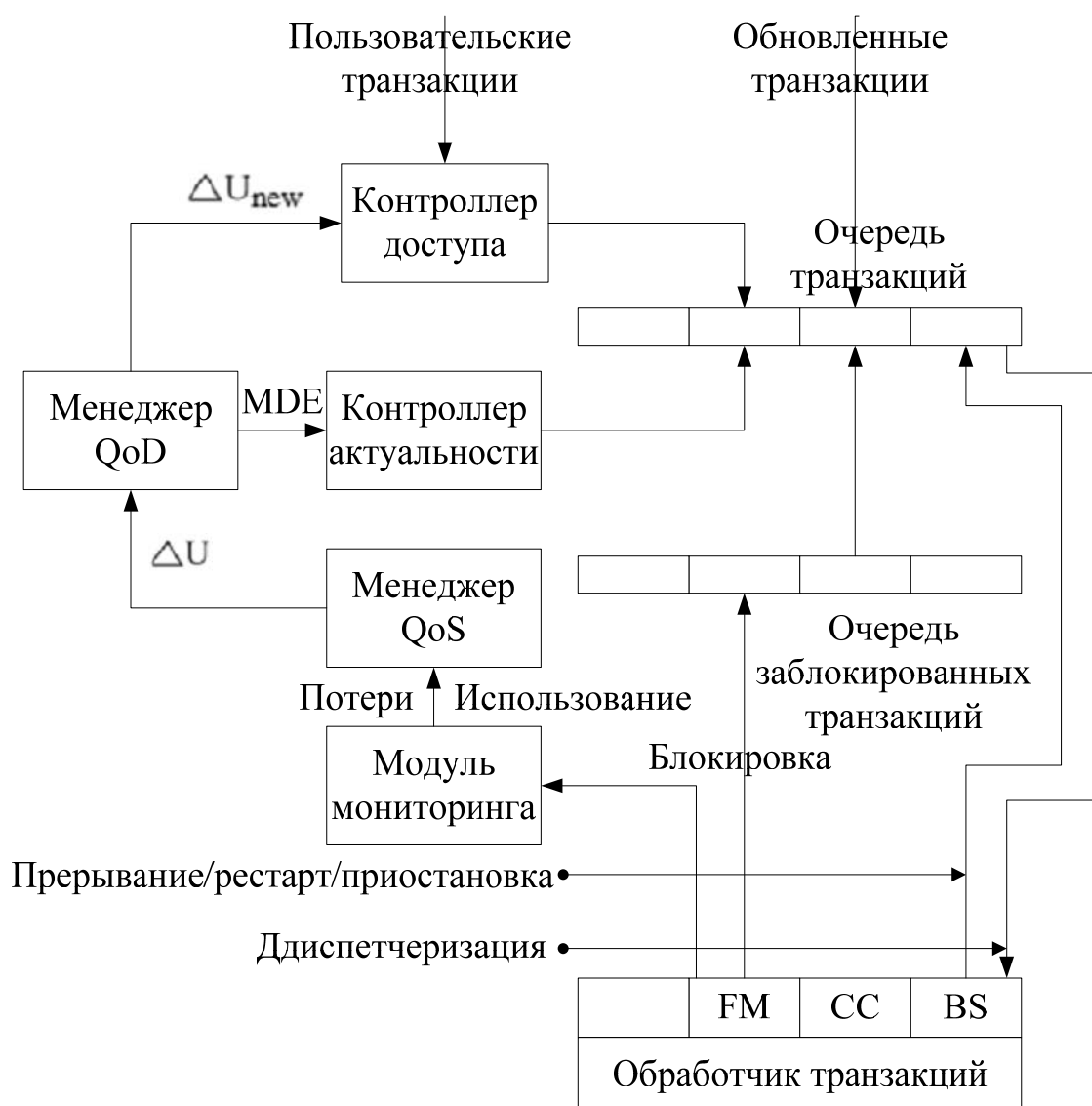
Рис. 3.1. Базовая архитектура СУБД РВ, основанная на управлении с обратной связью
