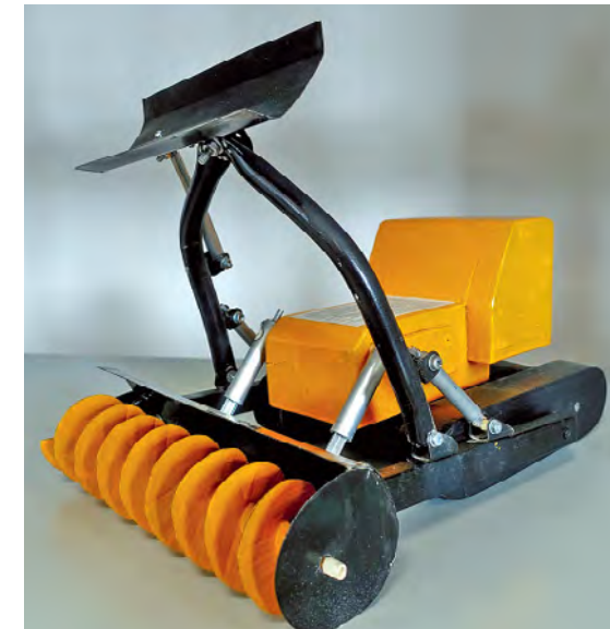
Модель траншеезасыпателя с винтовым конвейером. Цель изобретения – повышение качества создания дренажной линии за счёт регулирования соотношения крупных и мелких частиц грунта при обратной засыпке
