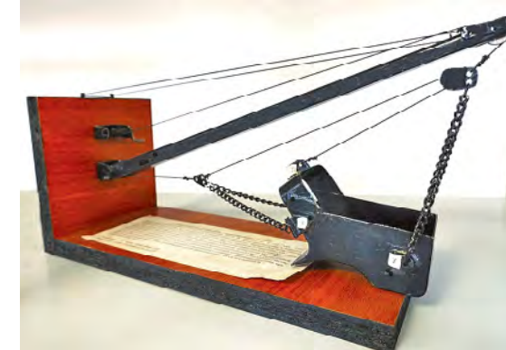
Ковш экскаватора-драйглайна с криволинейным дном. Цель изобретения – повышение эффективности разработки грунтов различной прочности за счёт снижения энергоёмкости процесса копания
