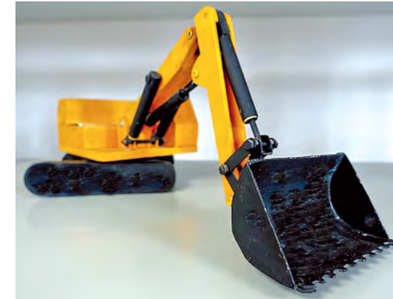
Рабочее оборудование бульдозера. Отличается тем, что снабжено угловыми ограничителями для повышения надежности и долговечности конструкции, устранения перегрузок шарнирных соединений
