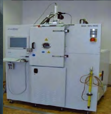
Используемые в работе установки для синтеза ННК ВАК-1
