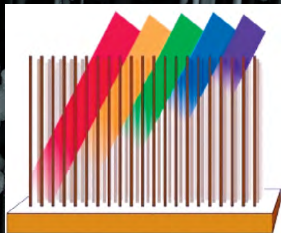
Схематическое изображение смесителя частот на основе разветвленного ННК и модифицированного нитевидными нанокристаллами фотоэлектрического преобразователя солнечного излучения
