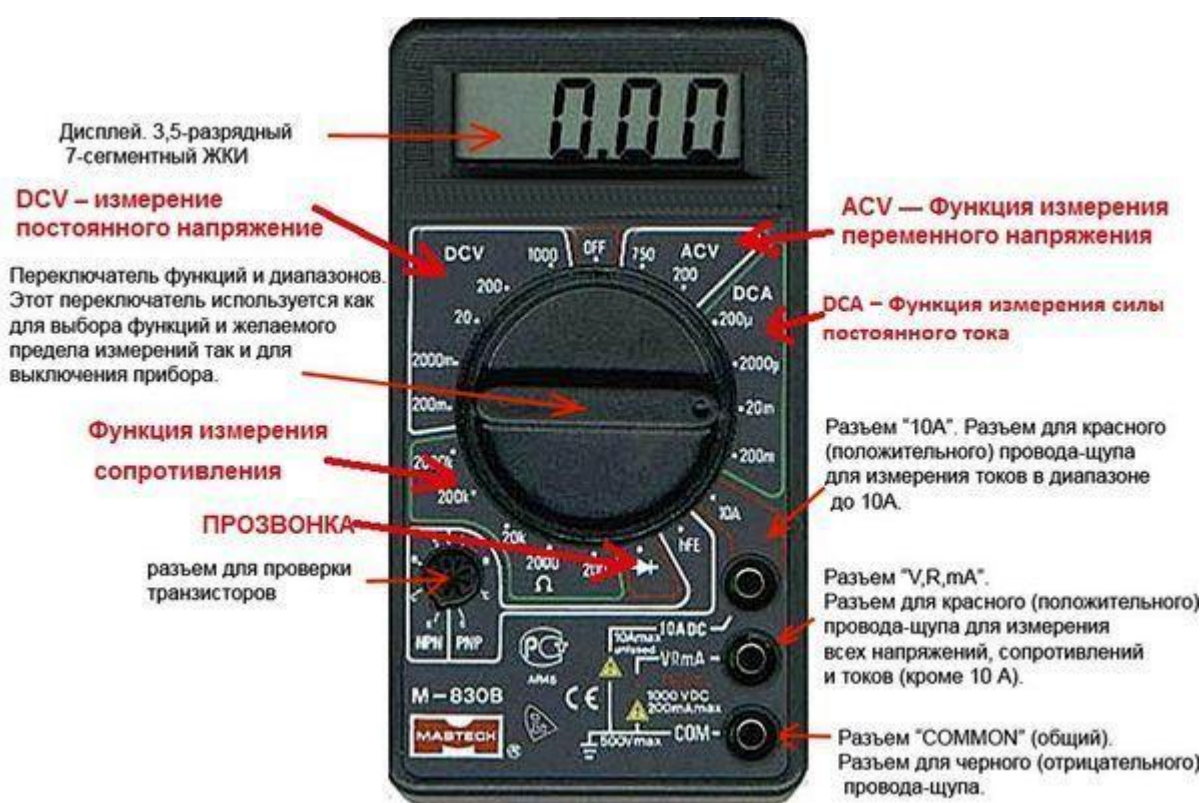
Рисунок 13 – Расположение органов управления мультиметра серии 830-832
