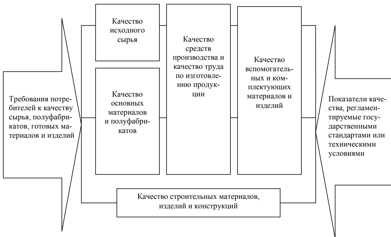
Рис. 1.6. Качество строительных материалов, изделий и конструкций
