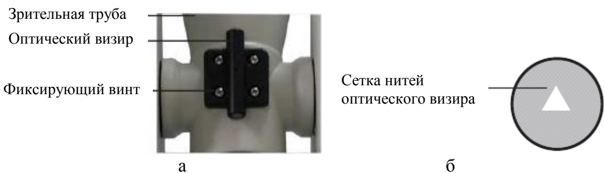
а) общий вид; б) сетка нитей Рисунок 1.19 – Оптический визир
