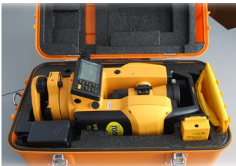
Рисунок 1.2 – Стандартная комплектация электронного теодолита VEGA TEO-5B
