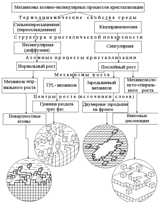
Рис. 2. ТЛ (ТРЛ) - механизм в ряду моделей атомно – молекулярных процессов роста кристаллов
