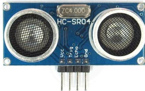
**Рис. 26.** Внешний вид УЗ дальномера
