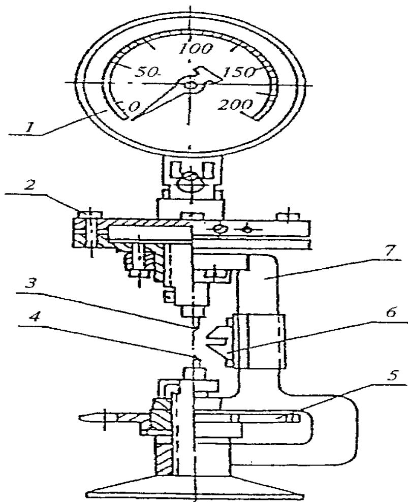
1 - манометр; 2 - гидравлическая мессдоза; 3 - верхний зуб; 4 - нижний зуб;
