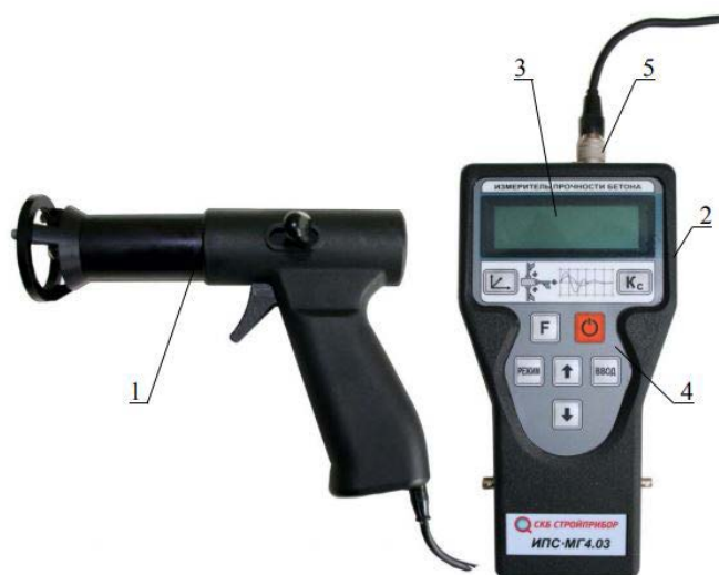
Рис. 1.9 Измеритель прочности бетона ИПС-МГ4: 1 – преобразователь в виде ударного механизма, 2 – электронный блок, жидкокристаллический дисплей, 4 – клавиатура управления, 5 – соединительный разъем
