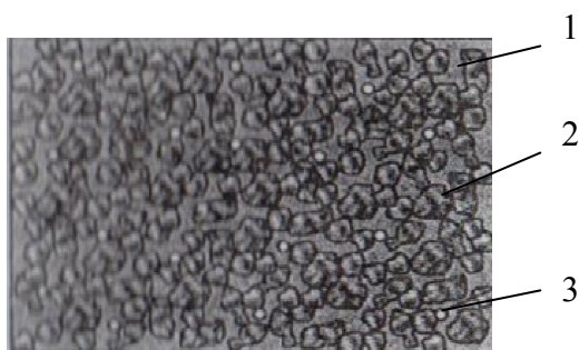
Рис. 6.2. Структура тяжелого бетона:
