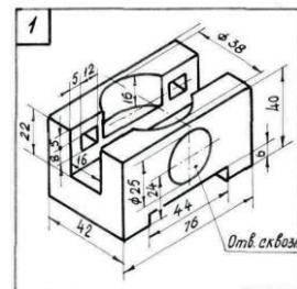
14. Выполнить сложный разрез детали.
