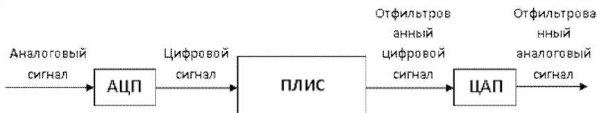
Рис. 1.4. Схема подключения АЦП и ЦАП к ПЛИС
