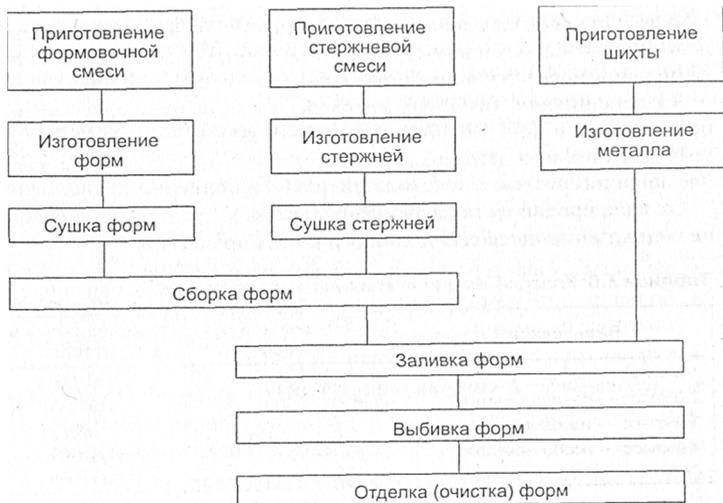
Рис. 8. Типовой процесс литья в песчаные формы
