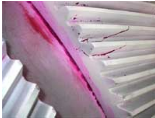
Рис. 7. Пример нанесения пенетранта
