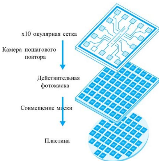
Рис. 6. Концептуальная иллюстрация метода пошагового повтора с уменьшением для облегчения производства СБИС
