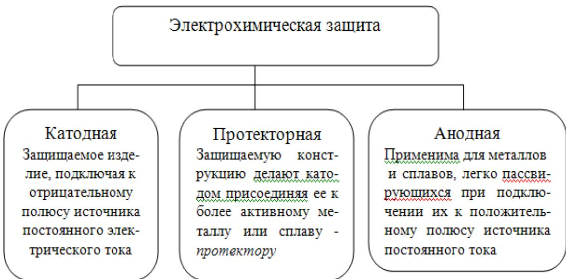
Рис. 5.2. Электрохимические способы защиты металлов и сплавов
