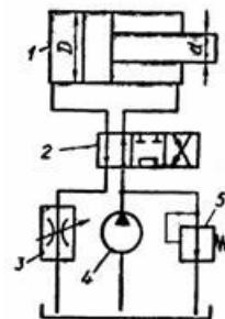
6. В объемном гидроприводе применяется гидромотор 1 с рабочим объемом  $V_0 = 50$  см<sup>3</sup>. При падении давления масла в гидролиниях-напорной  $\Delta P_h = 0,1$  МПа и сливной  $\Delta P_{sl} = 0,5$  МПа и утечке масла в гидроаппаратуре  $Q_{ut} = 0,1$  л/мин выходной вал гидромотора развивает полезный крутящий момент  $M =$
