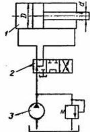
5. В объемном гидроприводе насос 4 развивает давление  $P_h = 5$  МПа и постоянную подачу  $Q_h = 8$  л/мин. Поршень диаметром  $D = 100$  мм и шток диаметром  $d = 40$  мм в гидроцилиндре 1 уплотняются резиновыми кольцами круглого сечения. Гидродроссель 3 настроен на пропуск расхода масла  $Q_{dr} = 8,4$  л/мин. Пренебрегая утечкой масла в гидрораспределителе 2, определить расход масла через гидроклапан 5 и потерю мощности из-за слива масла через этот клапан при перемещении поршня влево.
