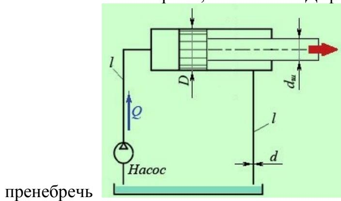
2. Определить режимы движения рабочей жидкости в питающей и отводящей линии гидропривода, изображенного на схеме в приведенной выше задаче. Скорость движения жидкости в питающей линии  $V_1 = 15,04$  м/с, скорость движения жидкости в отводящей линии  $V_2 = 10,08$  м/с, вязкость жидкости  $\nu = 0,5 \cdot 10^{-4}$  м $^2$ /с, диаметр трубопровода 0,012 м, критическое число Рейнольдса равно 2320.
