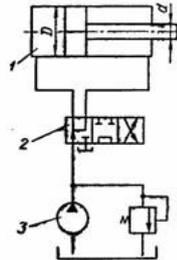
5. В объемном гидроприводе насос 4 развивает давление  $p_H = 5$  МПа и постоянную подачу  $Q_H = 8$  л/мин. Поршень диаметром  $D = 100$  мм и шток диаметром  $d = 40$  мм в гидроцилиндре 1 уплотняются резиновыми кольцами круглого сечения. Гидродроссель 3 настроен на пропуск расхода масла  $Q_{др} = 8,4$  л/мин. Пренебрегая утечкой масла в гидрораспределителе 2, определить расход масла через гидроклапан 5 и потерю мощности из-за слива масла через этот клапан при перемещении поршня влево.
