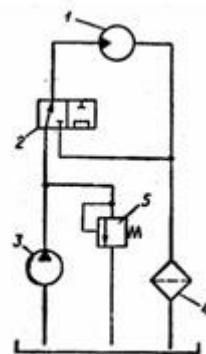
8. За время цикла  $T = 50$  с работы объемного гидропривода с гидроаккумулятором 2 гидромотор 1 работает всего  $t = 20$  с и развивает постоянную частоту вращения своего выходного вала  $n = 1500$  об/мин. Расход масла гидромотором  $q = 50$  см<sup>3</sup>. Определить маневровый объем  $W_m$  гидроаккумулятора и подачу  $Q_h$  насоса 3. Коэффициент запаса подачи насоса  $k = 1,1$ .
