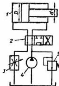
6. В объемном гидроприводе применяется гидромотор 1 с рабочим объемом  $V_0 = 50$  см<sup>3</sup>. При падении давления масла в гидрелиниях-напорной  $\Delta p_H = 0,1$  МПа и сливной  $\Delta p_{сл} = 0,5$  МПа и утечке масла в гидроаппаратуре  $Q_{ут} = 0,1$  л/мин выходной вал гидромотора развивает полезный крутящий момент  $M =$
