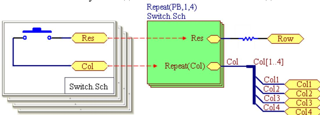
а) Создаём Sheet Symbol и указываем ему Filename нужной подсхемы. Из шины выводим наши сигналы в стиле `_BusName__StartNum_..._BusName__StopNum_` и разводим их куда надо.
