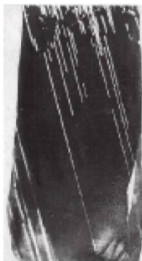
Рис. 1.3. Двойниковые ламели на торце монокристаллического слитка, обнаруживаемые после химического травления
