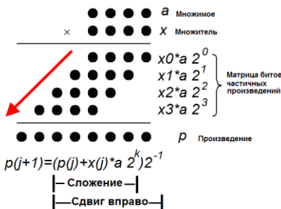
Рис.1.19. Представление процесса умножения методом правого сдвига и сложения в точечной нотации
