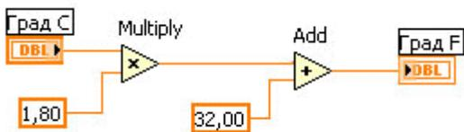
Рис.4. Блок-диаграмма ВП «Преобразование температуры»
