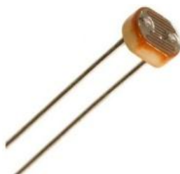
Рис. 2. Фоторезистор, изготовленный в виде дискретного прибора
