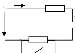
2. Цепь постоянного тока состоит из индуктивности  $L = 0,1\ \text{Гн}$  и двух резисторов с сопротивлениями  $R = 10\ \text{Ом}$  и  $R_1 = 30\ \text{Ом}$ . Приложенное напряжение  $U = 120\ \text{В}$ .
