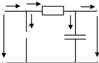
1. Четырехполосник, схема которого приведена на рисунке, имеет параметры  $R = X_L = 10\ \text{Ом}$ ,  $X_C = 20\ \text{Ом}$ . Определить коэффициенты А-формы записи уравнений четырехполосника и убедиться, что результаты удовлетворяют соотношению  $AD - BC = 1$ .
