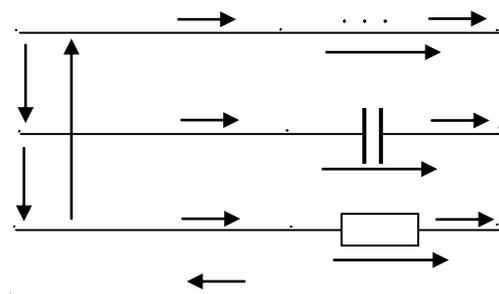
нагрузке, соединенной по схеме звезда с нулевым проводом, сопротивление которого равно нулю (рис. 3.10). Питание осуществляется от источника с линейным напряжением  $U_{л}=220\text{В}$ , сопротивления фаз нагрузки:  $Z_a = -jX_L = j100\ \text{Ом}$ ,  $Z_b = -jX_C = -j100\ \text{Ом}$ ,  $Z_c = R = 100\ \text{Ом}$ . Построить топографическую диаграмму, совмещенную с векторной диаграммой токов.
