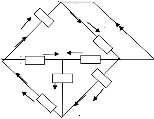
Задача 2. Составить систему уравнений по законам Кирхгофа для определения токов в ветвях схемы рис. 1.25 и записать ее в матричной форме.
