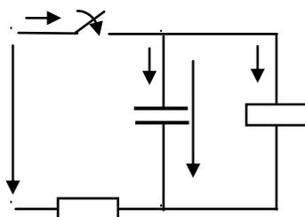
1. В электрической цепи, схема которой показана на рис., происходит коммутация. Найти зависимость от времени токов ветвей и напряжения конденсатора при переходном процессе.
