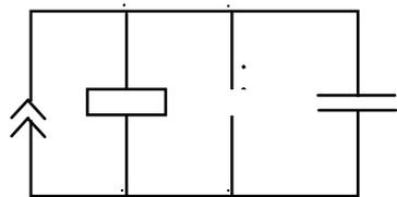
2. Схема питается от источника периодического не-синусоидального тока частотой 50 Гц, изменяющегося по закону  $j(t) = 1 + 1,57 \cos \omega t + 0,67 \cos 2\omega t - 0,12 \cos 4\omega t$ .
